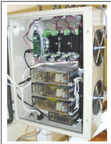
Figura 2. Gabinete del controlador del robot
