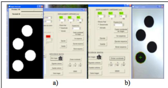
Figura 7. Ventanas de la detección de objetos.
