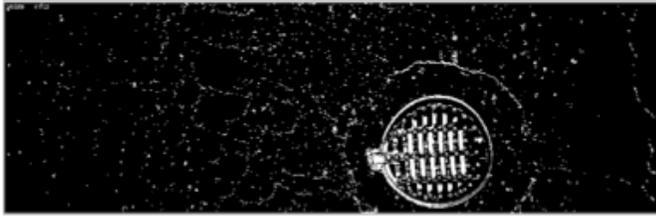
Figura 8. Imagen binaria de la transformada Wavelet aplicada a una imagen con la iluminación corregida.
