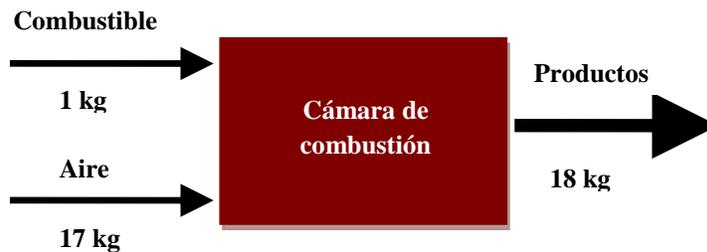
**Figura 2.6 Relación aire/combustible representada en masa.**
