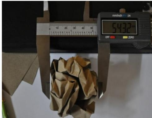
Fig. 10 Medidas de los diámetros de las probetas.
