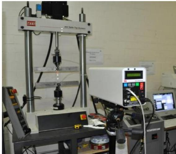
Fig. 5 Máquina de ensayos universales MTS-858
