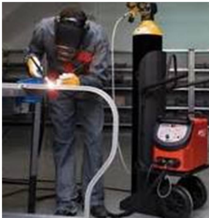
**Figura I.13.-** Sistema de soldadura tipo MIG
