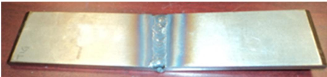
**Figura V.7.-** Probeta utilizada en el análisis experimental TIG
