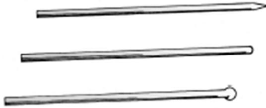
**Figura II.3.-** Posibles formas del electrodo de Tungsteno
