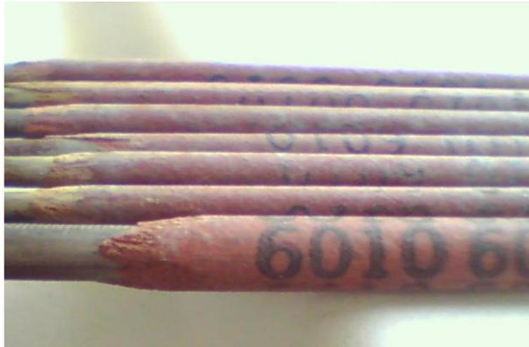
**Figura I.8.-** Electrodo con recubrimiento empleado en la actualidad
