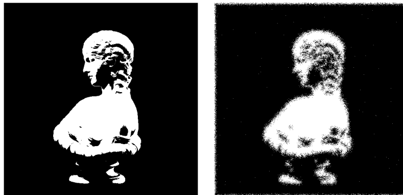
Figura 5.12: Resultado después de aplicar el algoritmo que simula la generación de ruido en los bordes; con 15 % de ruido
