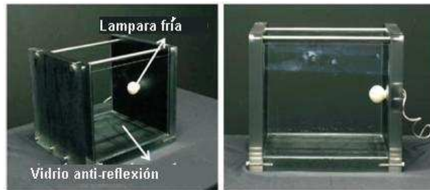
Figura 2.6: Dispositivo de captura de propiedades de dispersión en medios participantes diluidos
