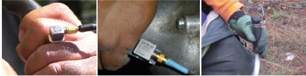
**Figura 4.5:** Formas de montaje del acelerómetro para mediciones en extremidades superiores.
