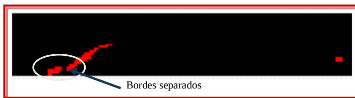
Figura 23. Separación de bordes que representan el defecto de la botella de vidrio.
