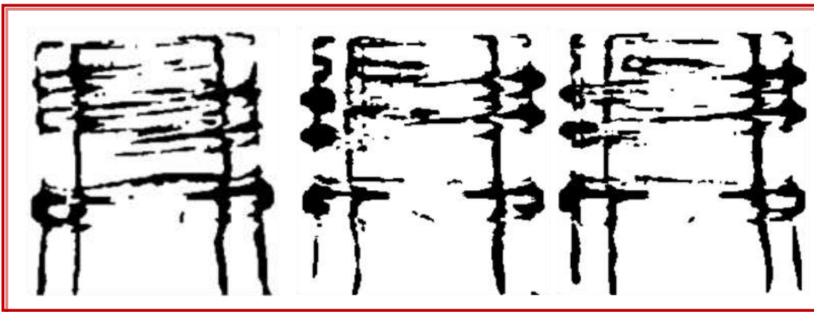
Figura 9. Realce de bordes con elemento de estructura Fila de 1x3 píxeles.
