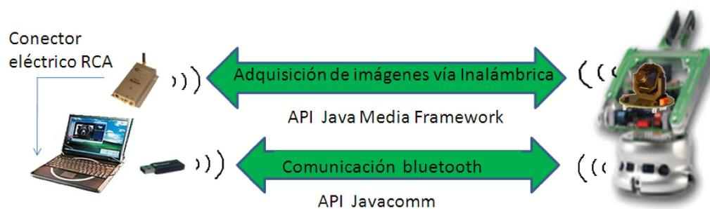
Figura 4.1: Esquema de comunicación inalámbrica
