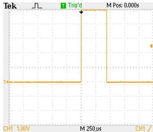
**Figura 5.10** Salida del puerto C, RC5, tiempo que tardó la señal enviada en regresar.
