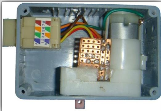
*Figura 4.27* Motor con caja plástica.
