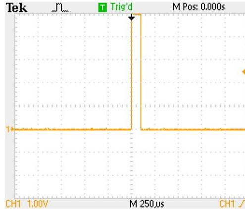
**Figura 5.11** Un objeto detectado a menor distancia, por la señal de eco.
