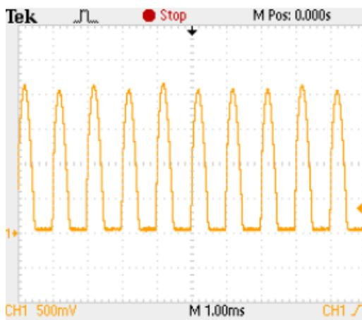
**Figura 5.3** Punto número 2, señal tomada de la salida del primer amplificador operacional.
