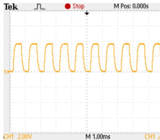
**Figura 5.5** Punto número 4, salida del sensor de sonido, lectura que tomará el convertidor analógico digital del microcontrolador.
