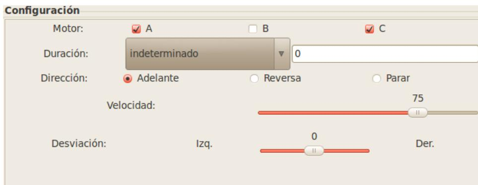
**Figura 4.14** Parámetros del bloque de motor.
