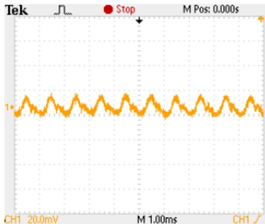
**Figura 5.2** Punto número 1, señal captada por el micrófono y aplicada al primer paso de amplificación.
