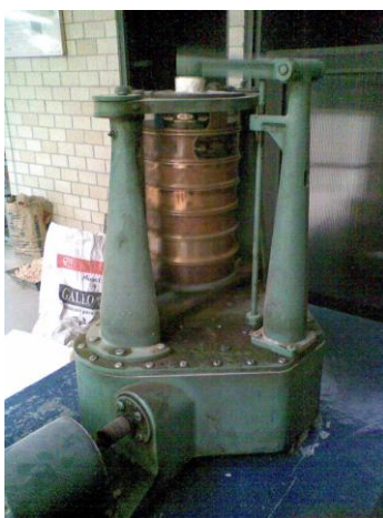
Figura 14. Equipo utilizado para la prueba de granulometría (Ro-Tap)
