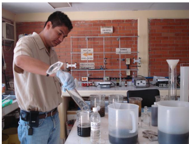
Figura 26. Ensayo de lixiviado en laboratorio
