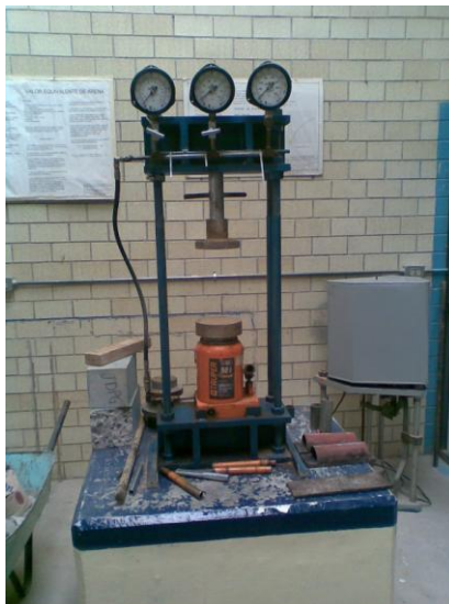
Figura 16. Máquina para aplicar carga en la prueba de compactación porter
