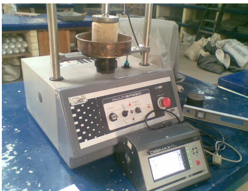
Figura 25. Especimen sometido a carga para obtener su VRS.
