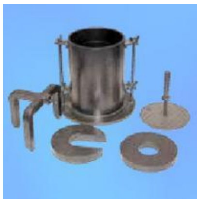
Figura 17. Molde con base, extensión y sobrepesos para la prueba de expansión
