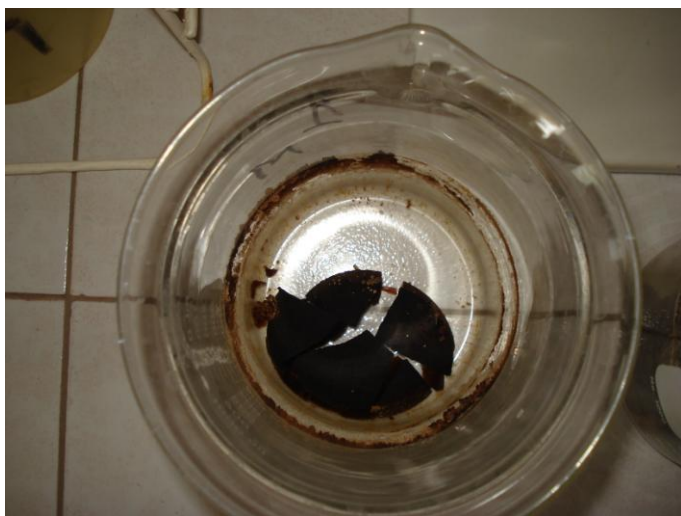
Figuras 31 y 32. Residuos de lixiviado en estado sólido después de ser mezclado con estabilizador
