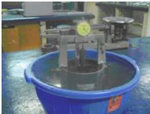
Figura 18. Especimen saturado para la prueba de expansión
