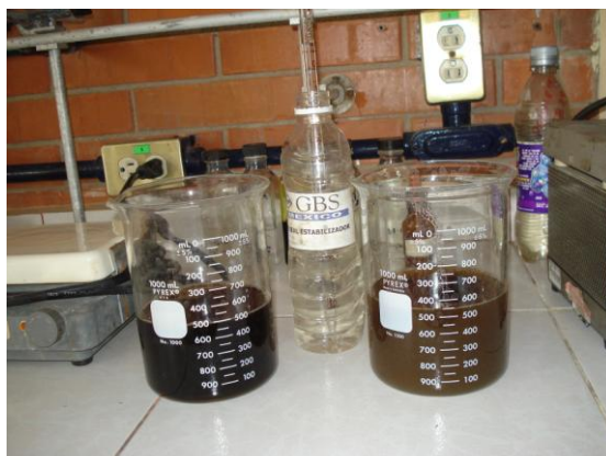
Figura 29. Muestras de lixiviado mezclado con el estabilizador
