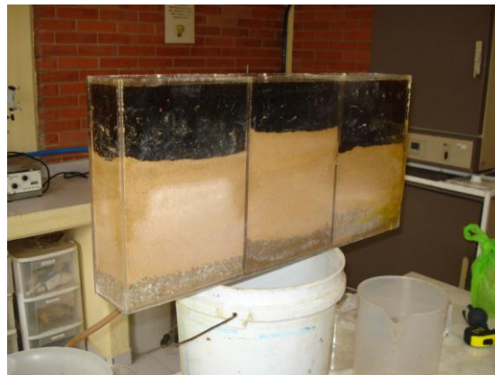
Figura 36. Prueba de permeabilidad en laboratorio utilizando lixiviados
