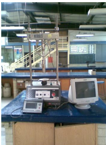
Figura 19. Equipo de penetración computarizado para la prueba del valor relativo de soporte
