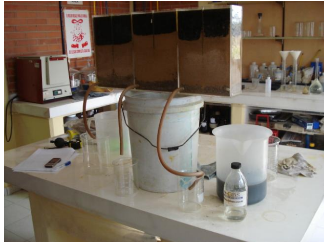
Figura 34. Prueba de permeabilidad en laboratorio utilizando lixiviados
