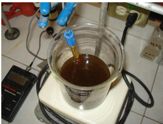
Figura 27. Medición del pH del lixiviado ensayado
