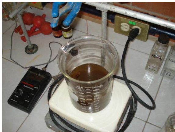
Figura 28. Mezcla de lixiviado con estabilizador y agitación
