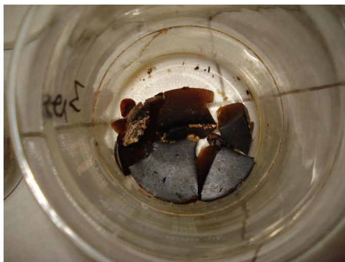
Figuras 31 y 32. Residuos de lixiviado en estado sólido después de ser mezclado con estabilizador
