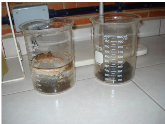
Figura 30. Residuos de lixiviado después de 20 días de reposo
