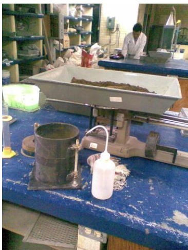
Figura 20. Equipo utilizado para la prueba de peso volumétrico seco y suelto
