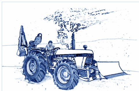
Figura 4. Tractor agrícola adaptado para las operaciones del relleno sanitario 8
