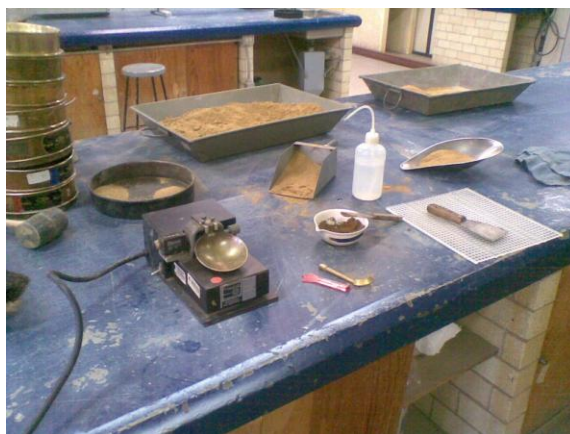
Figura 12. Equipo utilizado en la prueba de límite líquido
