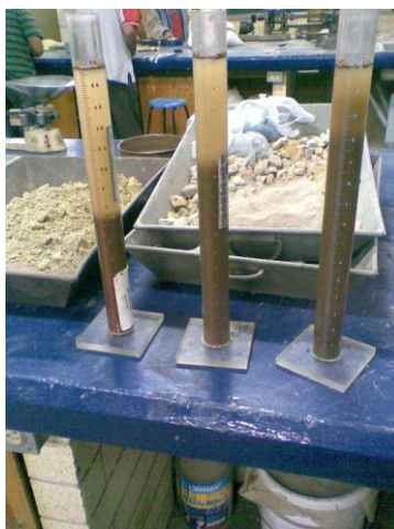
Figura 15. Probetas graduadas para la prueba de equivalente de arenas
