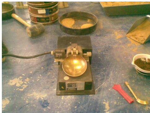
Figura 13. Equipo utilizado en la prueba de límite plástico
