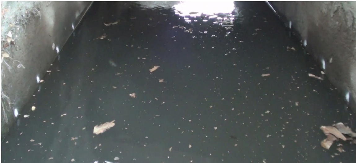
FIGURA 50. Hojas de árbol secas utilizadas como trazadores en el canal.
