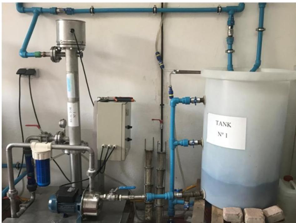
**Figura 13.** Sistema del reactor fotocatalítico piloto UBE.
