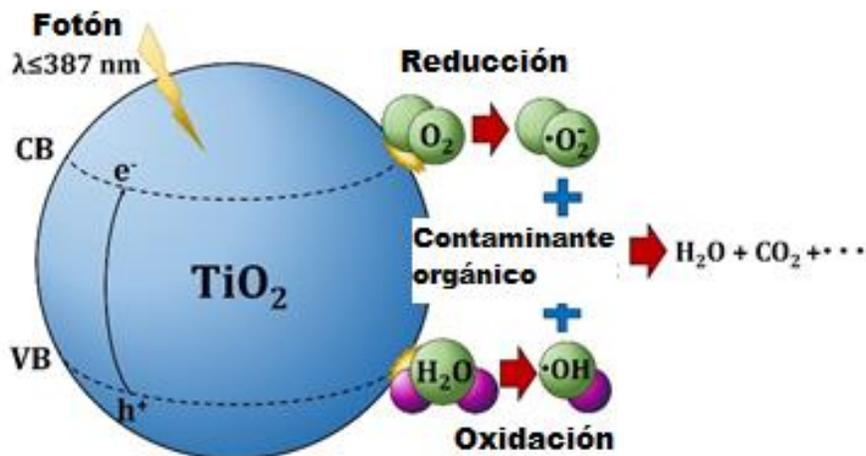
**Figura 5.** Mecanismo general de la fotocatalisis heterogénea.
