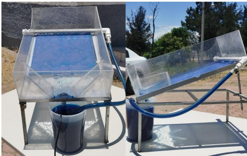
**Figura 9.** Reactor solar con superficie de área de contacto de  $1/10 \text{ m}^2$ .
