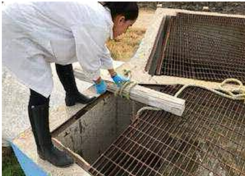
Figura 1. Recolección de agua residual en cárcamo de bombeo.
