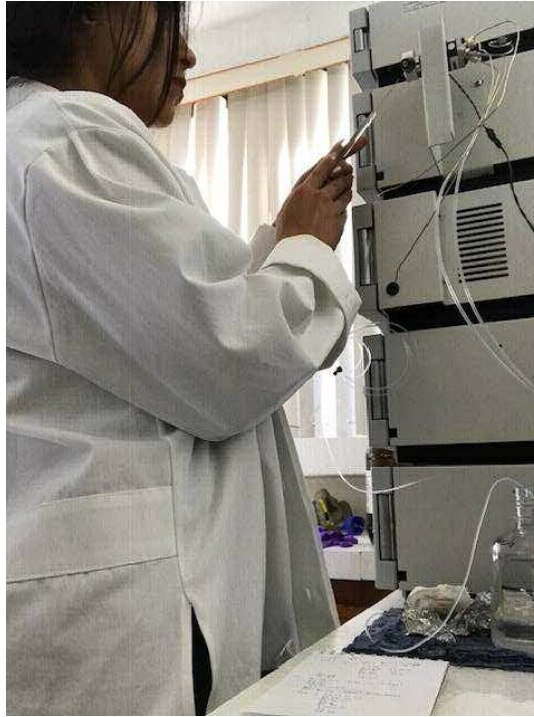
Figura 5. Inyección de muestras en el equipo HPLC.
