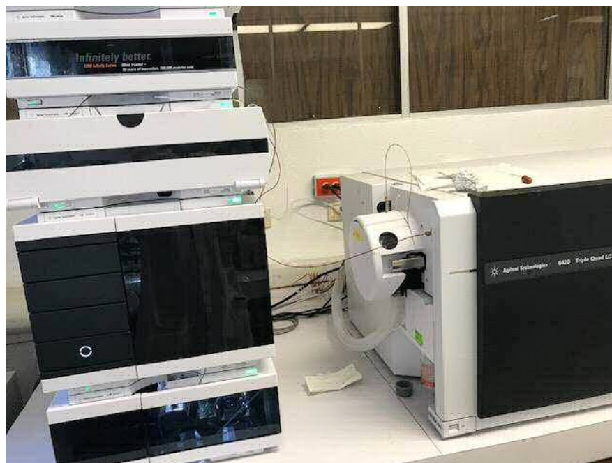
Figura 7. Equipo de detección de cromatografía líquida acoplado a espectrometría de masas.
