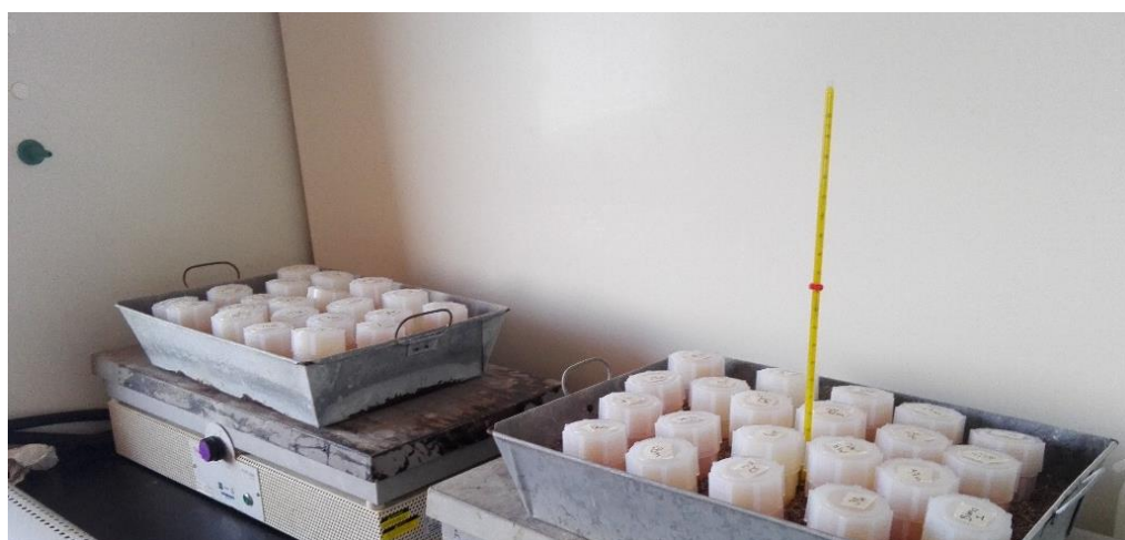
Figura 3. Digestión de muestras en recipientes savillex colocados en placas a 130^\circ\text{C} .
