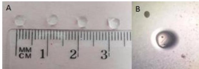
**Figura 2.** Perlas obtenidas con alginato de sodio 1 % y goteadas en cloruro de calcio al 10 % (A) Medición. (B) Vista al estereoscopio.
