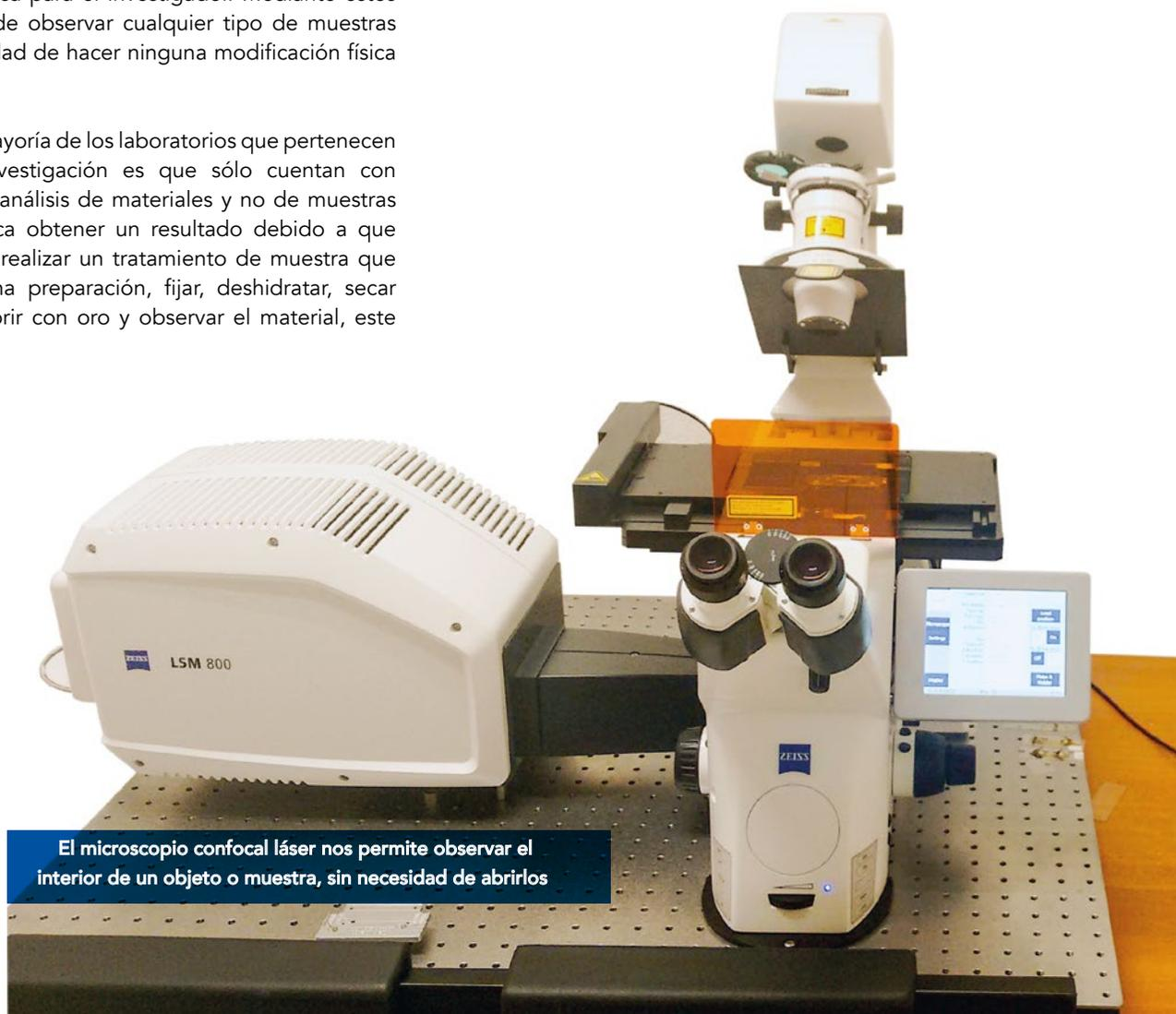
**El microscopio confocal láser nos permite observar el interior de un objeto o muestra, sin necesidad de abrirlos**
