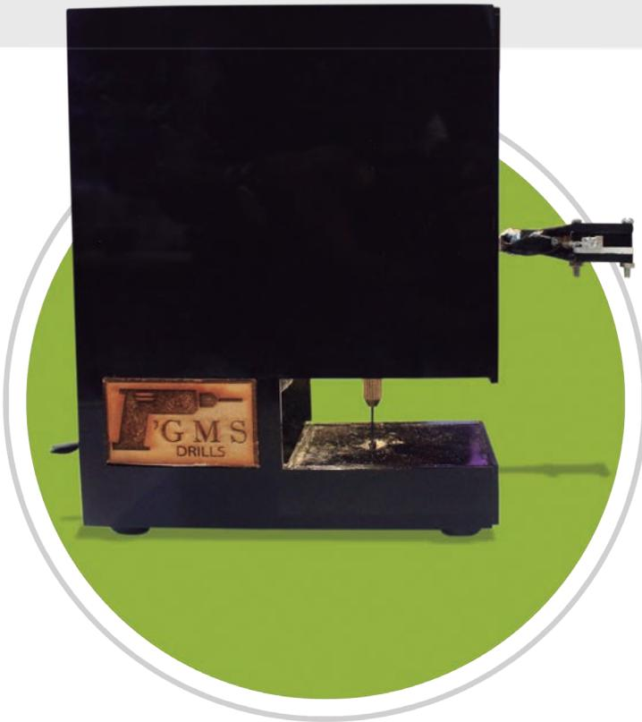
El prototipo tiene dos sistemas que lo hacen más funcional, el de iluminación que son luces leds y otro de ventilación con la finalidad de evitar que la máquina se caliente. (Foto: Antonio Montero)
