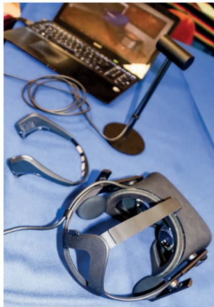
El equipo está conformado por la banda sensorial muse, que se coloca en la frente para analizar las ondas cerebrales beta, además del visor y la computadora.
