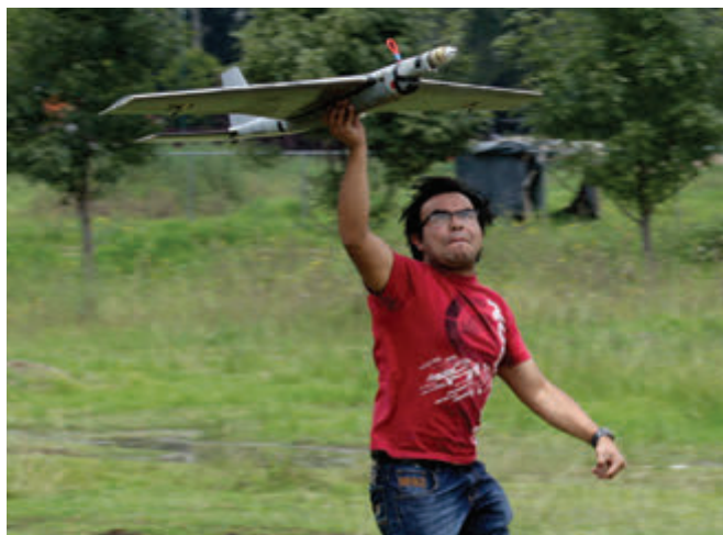
La aeronave es suficientemente flexible para lanzarla a mano sin necesidad de despegue en pista
