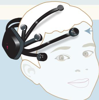
Se utilizó el dispositivo EPOC (diadema) interfaz cerebro-computadora, el cual reconoce las ondas cerebrales (alfa y beta) y transmite los resultados al sistema vía bluetooth para identificar el tipo de movimientos que el usuario desea realizar; al efectuar las diferentes acciones se emiten las ondas cerebrales como instrucciones al exoesqueleto.
