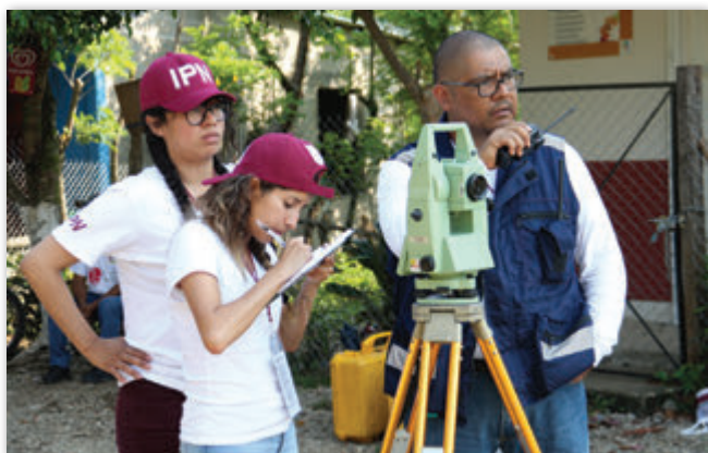
En Santa María Jacatepec, Oaxaca, los brigadistas hacen un levantamiento topográfico de diversas calles para proponer un plan de pavimentación. (Foto: Adalberto Solís)
