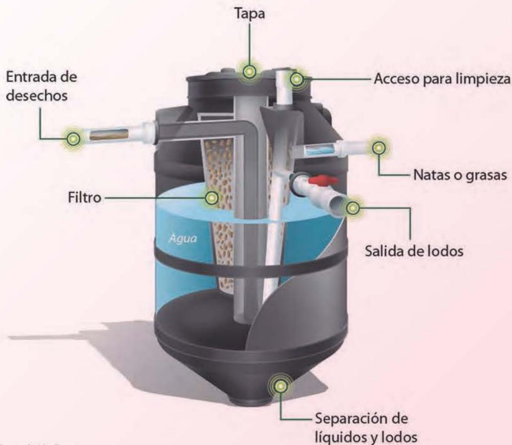
► Funcionamiento de biodigestor
