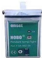
**Figura 3.** Dispositivo (HOBO®) utilizado para obtener los valores de temperatura e intensidad lumínica a la que están expuestas las colonias.
