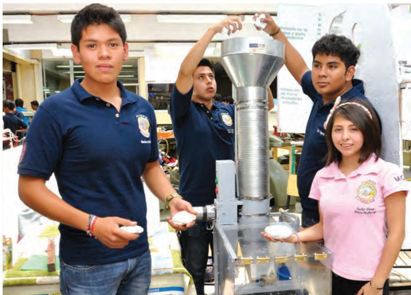
Con una cortadora, mezcladora y solvente, los jóvenes pueden obtener un bloque con características superiores a los ladrillos
