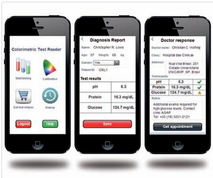
metrix, permite realizar la función que efectúa el equipo conocido como espectrofotómetro, el cual utiliza sensores similares a los de las cámaras fotográficas digitales para detectar fotones a diferentes niveles de energía que se corresponden con determinados colores o longitudes de onda de espectro electromagnético, e indica qué cantidad de la sustancia que nos interesa está presente en la muestra.
