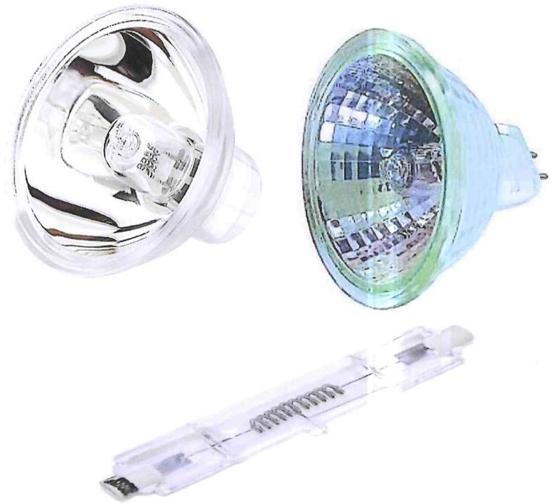
Las lámparas de halógeno son una variante de las incandescentes, pues tienen también un filamento de tungsteno contenido en un recipiente hermético con un gas a baja presión que contiene halógeno. Esto permite duplicar y hasta cuadruplicar la vida útil de la lámpara, pues el halógeno
