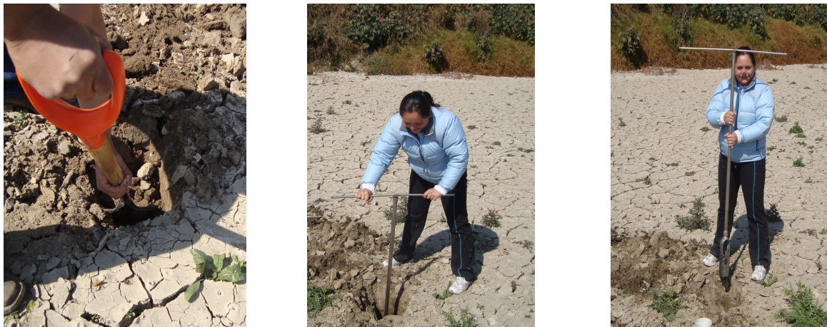
Figura 4.4 Toma de muestras con el nucleador
