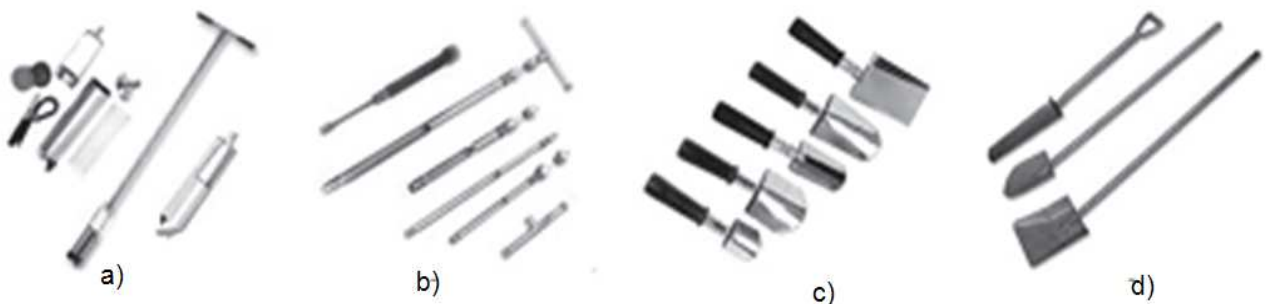
Figura 4.1 Instrumentos comúnmente usados para el muestreo de suelos: a) nucleadores; b) palanca "T"; c) espátulas; d) palas
