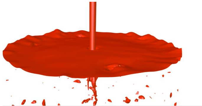
Figura 19 Movimiento de la interface aire-acero.
