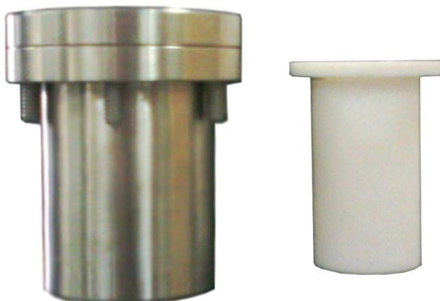
Figura 24 Autoclave con recipiente de teflón, empleada en la síntesis de las NPs de  $\text{HfO}_2$ .
