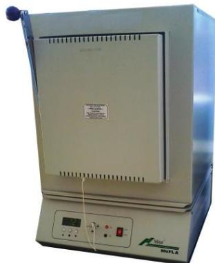
Figura 25 Mufla marca FELISA, empleada en la síntesis de NPs de  $\text{HfO}_2$ .
