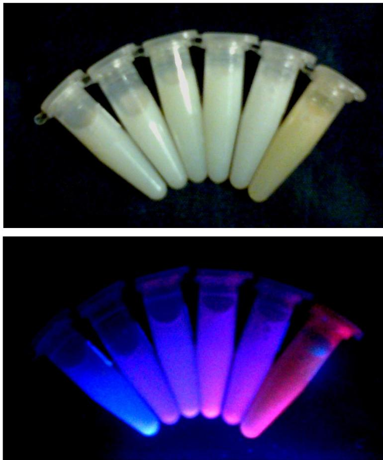
Figura 40 Fotos de las NPs de  $\text{HfO}_2:\text{Eu}^{3+}$  impurificadas de izq. a der. (0%, 1.3%, 2%, 3%, 5%, 7.5%), Temp. 120°C.  $\lambda_{\text{EX}}=254\text{nm}$ .
