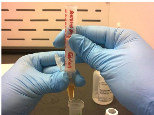
Figura 2.18. Etapa del proceso experimental de bioconjugación (ultrafiltración de los puntos cuánticos activados).
