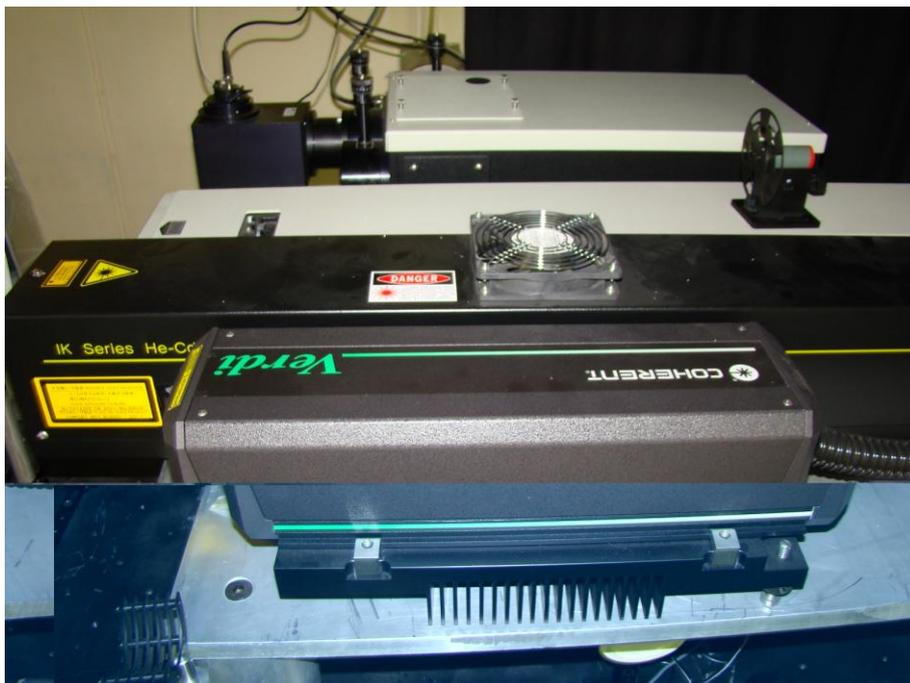
Figura 2.5. Equipo de Laser de He-Cd de 325nm y del laser de estado sólido de 535nm empleados en el laboratorio de optoelectrónica de la ESFM.
