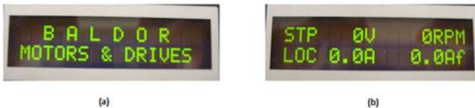
Figura 4-5 a) Pantalla principal del driver (b) Pantalla del estado del control digital
