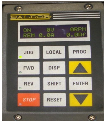
Figura 3-19 Display del control Baldor Serie 19H
