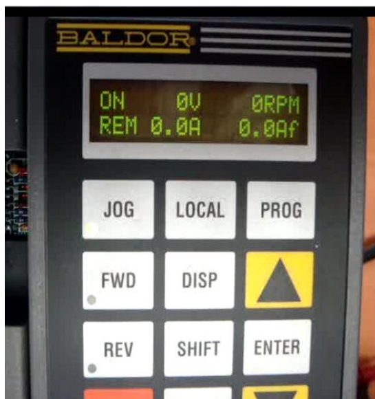
Figura 4-14 Modo remoto. Motor apagado
