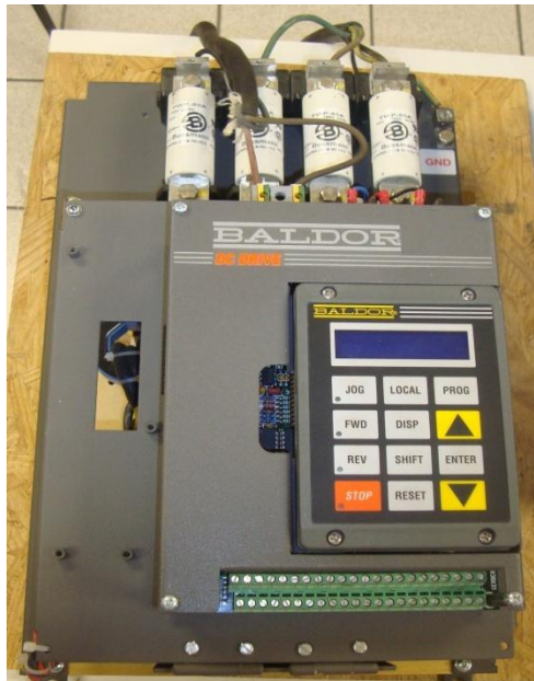
Figura 3-18 Control CC Digital Tipo SCR Serie 19H
