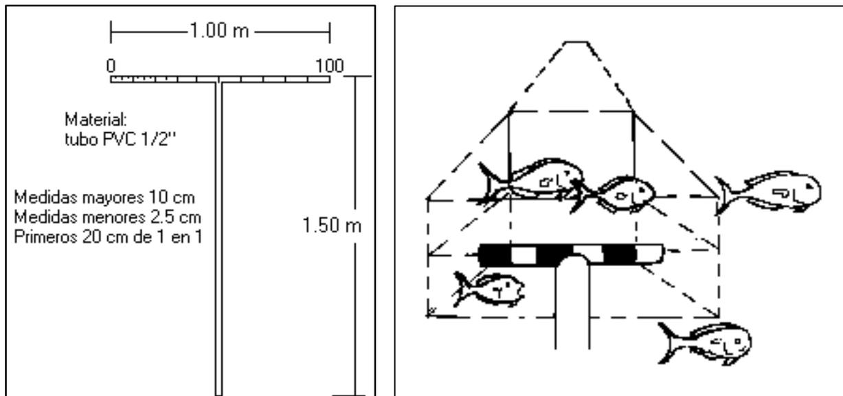
Figura 4.- Estructura de tubo de PVC hueco, con regla de medición para aproximar las medidas de los peces bajo el agua. (Tomado de Ginsburg, 2002).
