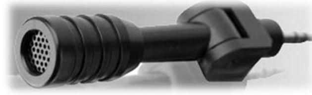
Figura 19: Micrófono para dotar de capacidad auditiva al robot móvil.
