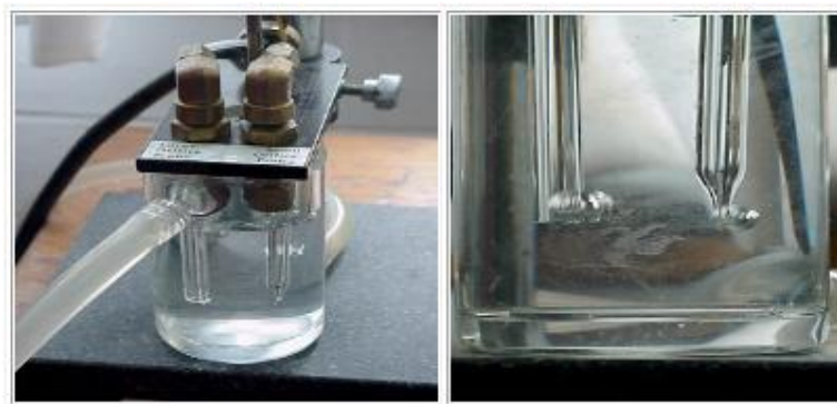
Figura 1.6. Equipo para Medición de T.S. por Máxima Presión de Burbuja
