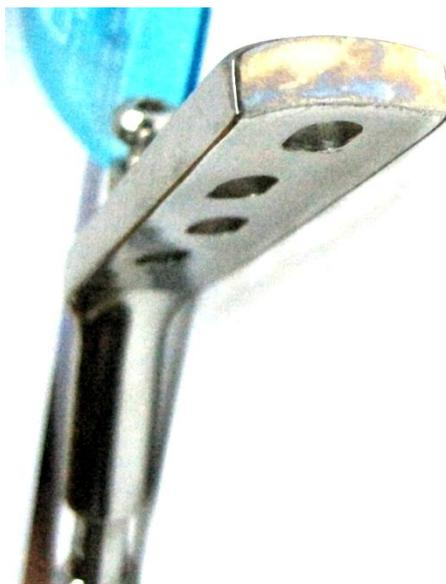
**Figura II.4.-** Prótesis con recubrimiento de  $\text{TiO}_2$  y nanopartículas de oro en uno de sus extremos
