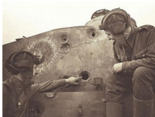
Figura I.3.- Inspección de blindajes en tanques en búsqueda de grietas para fortalecimiento
