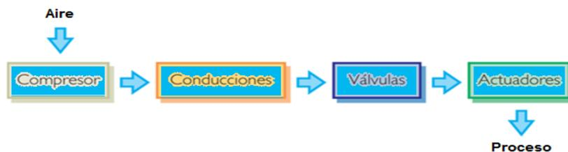
Fig. 3.14 Esquema básico de un sistema neumático. (Blas, 2006).
