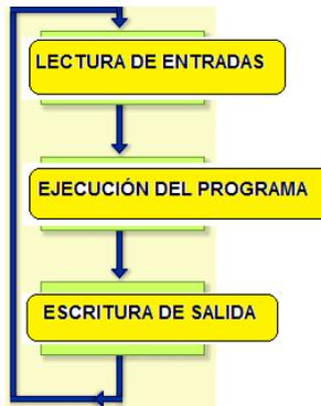
Fig. 2.12 Proceso de funcionamiento del PLC
