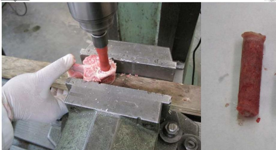
Figura 2: obtención de la probeta con un taladro de banco y un sacabocados.
