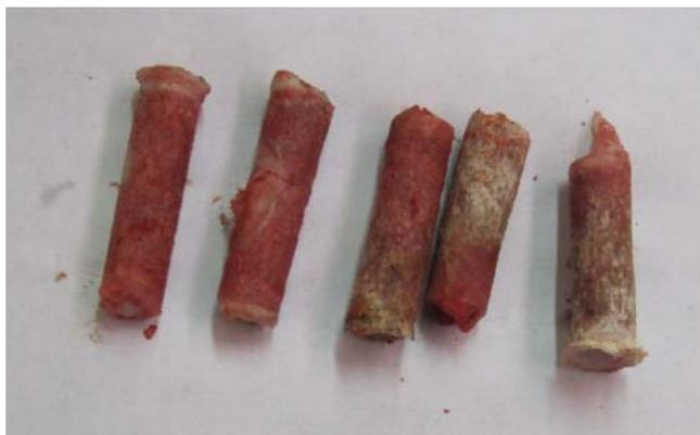
Figura 5: Cilindros maquinados a 2 velocidades, los 2 de la izquierda a 618 rpm y los 3 de la derecha a 927 rpm.
