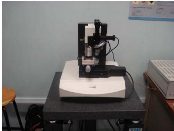
Figura 3.7 Nanoindentador TTX-NHT, CSM Instruments (Cortesía: Centro de Nanociencias y Micro y Nanotecnología, del Instituto Politécnico Nacional).
