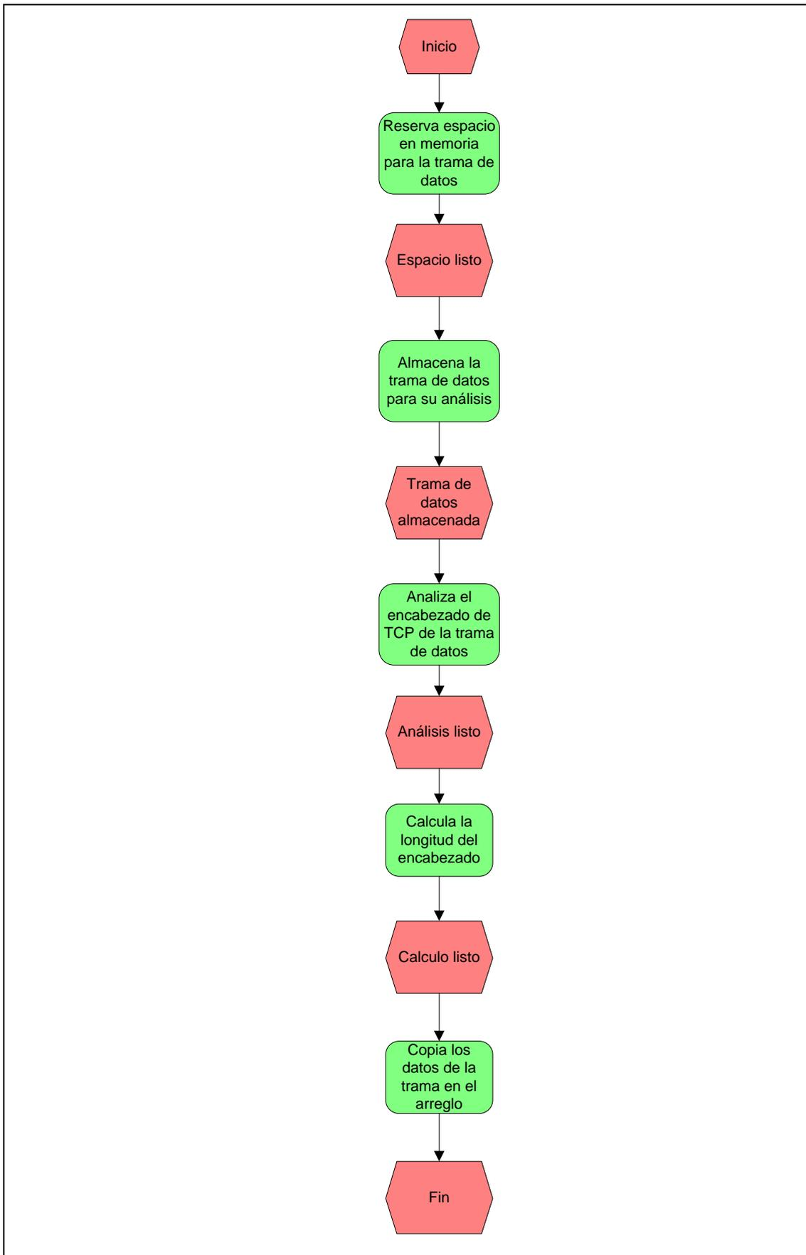
Figura.3.14. – Diagrama ECP función TCPHeader
