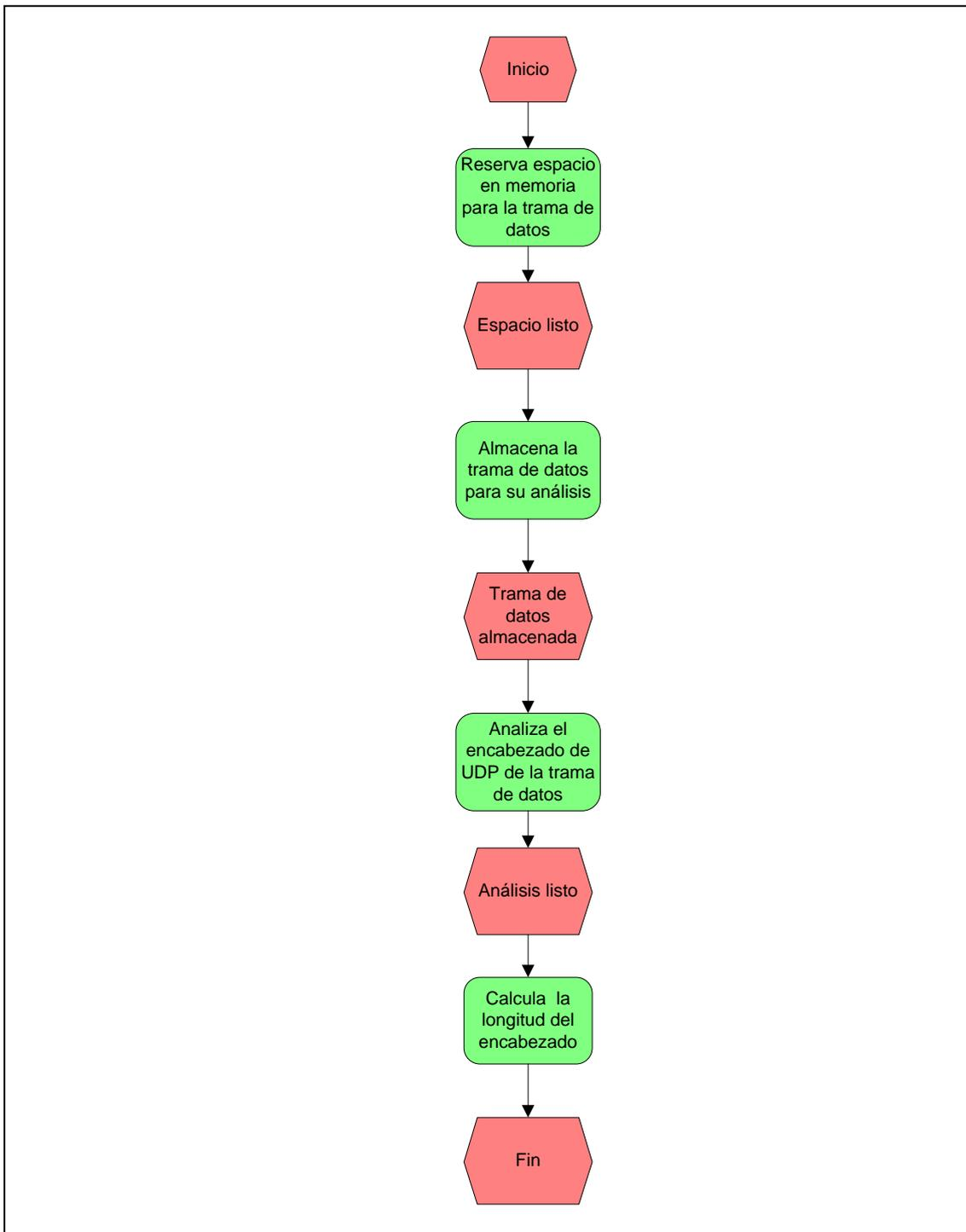
Figura.3.18 Diagrama EPC de la función UDPHeader.
