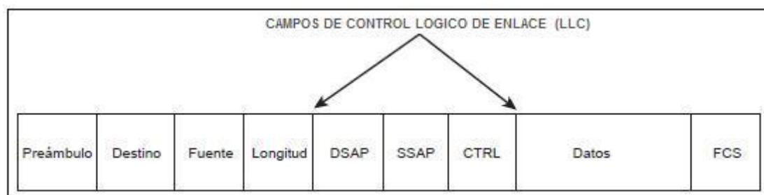
Figura A.3 Trama de datos Ethernet. [10]
