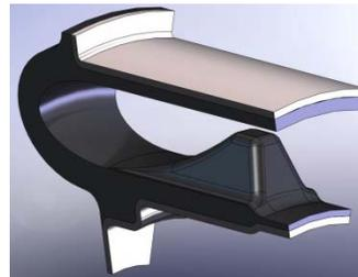
Perfil de hule aprobado bajo las especificaciones del cliente y pruebas en campo. Condiciones de temp. 130<sup>o</sup>c expuesta en 30 min. Condición a baja temp. es: -40<sup>o</sup>c con desplazamiento axial de ±7mm a 2Hz durante 1.0 M de ciclos.[4]
