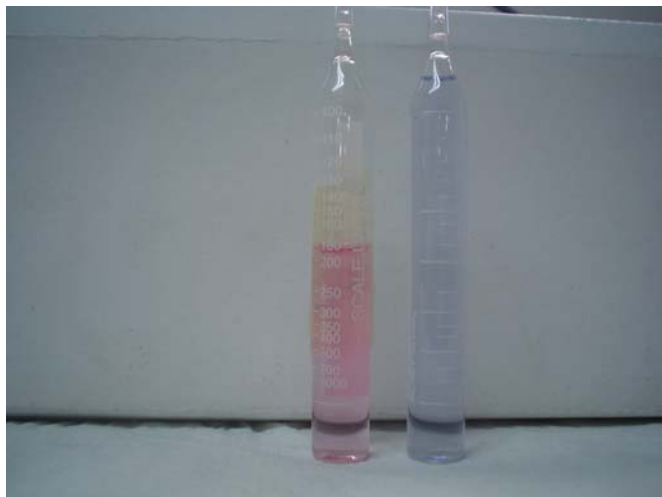
Figura 42. Dureza del agua de Aguascalientes, antes y después del tratamiento por electrocoagulación.
