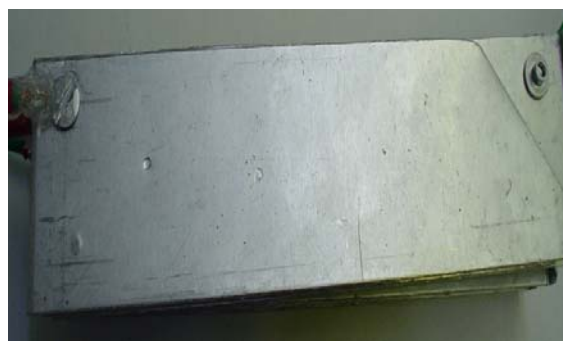
Figura 9. Diseño de una placa de aluminio para emplearse como electrodos
