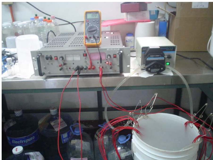
Figura 41. Sistema de electrocoagulación escalado a 20L.
