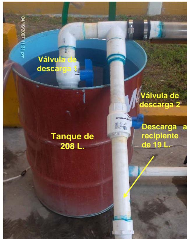
Figura 5.8 Sistema de Descarga y Medición de Flujo Real
