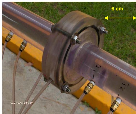
Figura 5.4. Placa de Orificio y Tomas de Presión en la Tubería Principal
