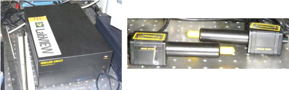
Figura 58. A la izquierda se muestra el sistema de control electrónico 11NSC101 y a la derecha se muestran los motores a pasos utilizados para realizar los movimientos de la plataforma.
