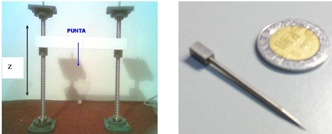
Figura 54. A la izquierda se muestran los tornillos embalados y a la derecha se muestra la punta de tungsteno utilizada.
