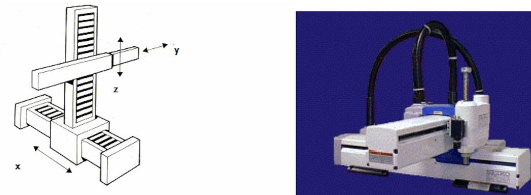
Figura 45. Representación de un robot configurado cartesianamente.
