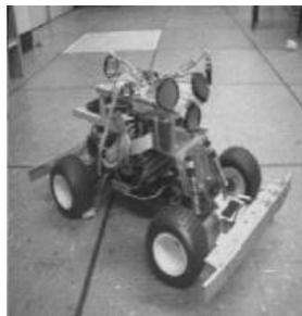
*Figura 24. Foto de un prototipo de un robot móvil.*
