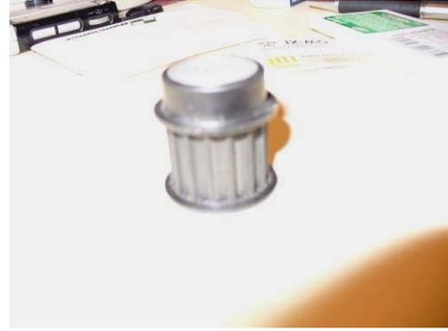
Figura 56. A la derecha se muestra el buje sujetado a la flecha del motor; a la derecha se muestra una de las dos poleas dentadas.
