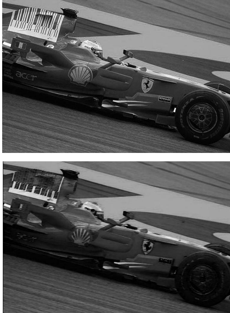
Figura 7 Erosión de una imagen usando como EE un 4 \times , obsérvese que las líneas delgadas sobre el auto en la imagen erosionada (inferior) aparecen mucho más oscuras.
