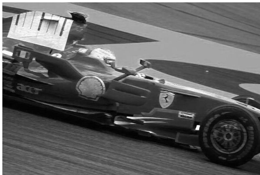
Figura 8 Resultado de la dilatación de la misma imagen que en la Figura 7 y utilizando el mismo EE de 4x1. Por el contrario de la erosión, obsérvese el aclaramiento y desaparición de delgados detalles oscuros en comparación con la figura original.
