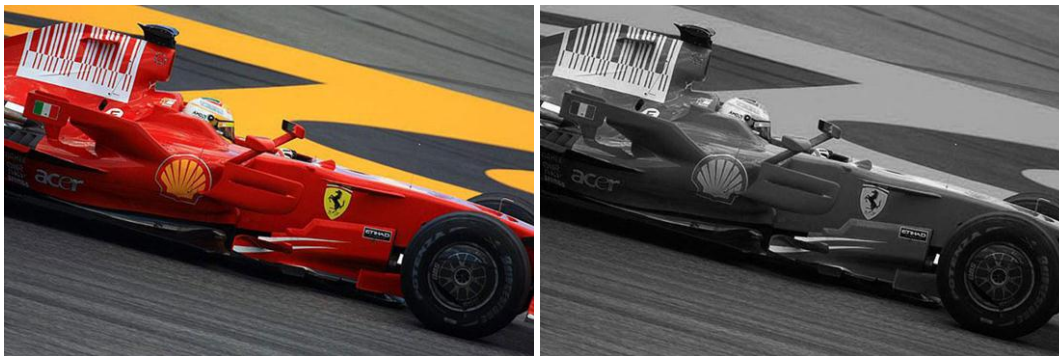
Figura A3 La transformación de una imagen en color RGB hacia tonos de grises, implica la media aritmética entre las intensidades de los tres canales de color.
