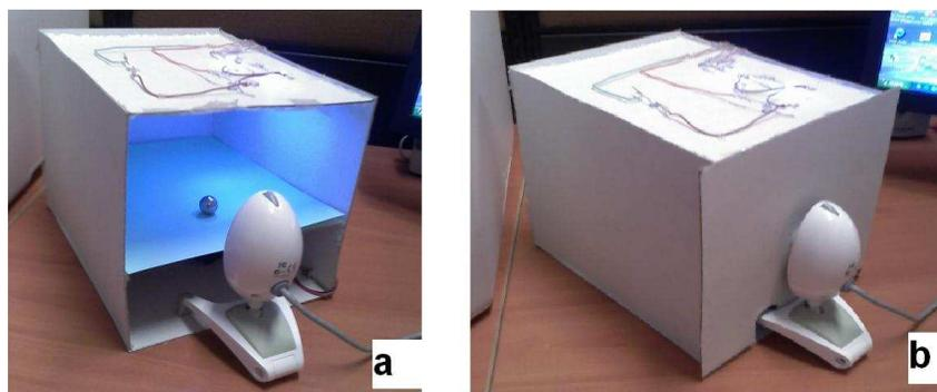
Figura 4.5: Sistema de adquisición de imágenes de referencia
