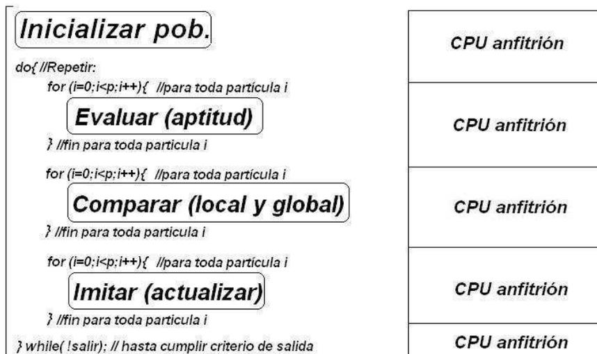
Figura 5.1: Esquema para el algoritmo PSO secuencial
