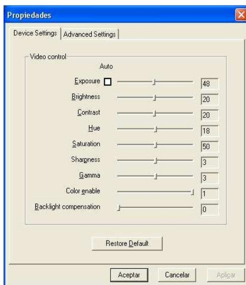
Figura 4.6: Parámetros usados en la cámara de adquisición
