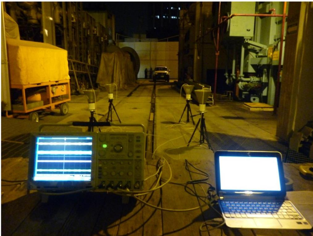
**Figura No. 64.** Colocación de las antenas para monitoreo completo de la subestación.
