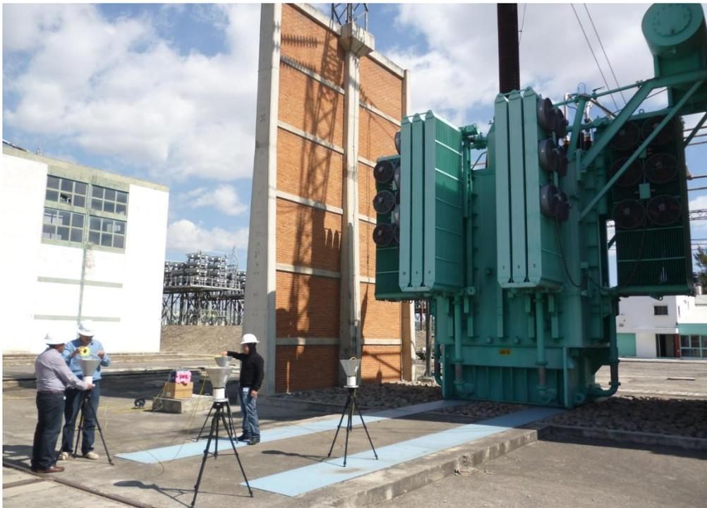
**Figura No. 57.** Arreglo del sistema para la toma de la huella patrón del Transformador de potencia
