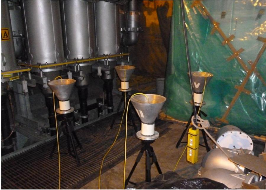
**Figura No. 62.** Colocación de las antenas en la caseta del GIS en el lado de 230 kV.
