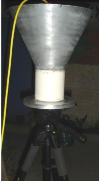
**Figura No. 16.** Antena díscono utilizada en el sistema.
