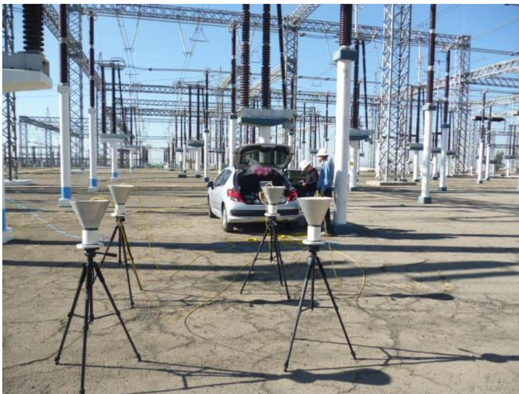
**Figura No. 48.** Ubicación del equipo para la captura de Señales de descargas parciales.
