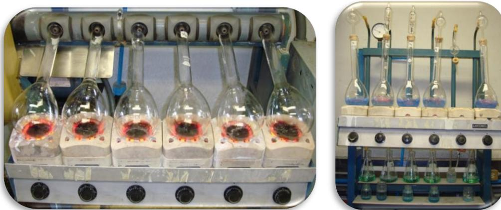
Figura 11. Determinación de proteína por el método Kjeldahl.
