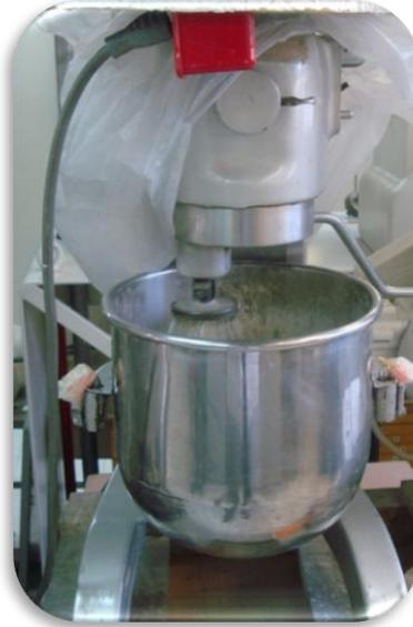
Figura 13. Mezcladora empleada para la humectación de las materias primas.
